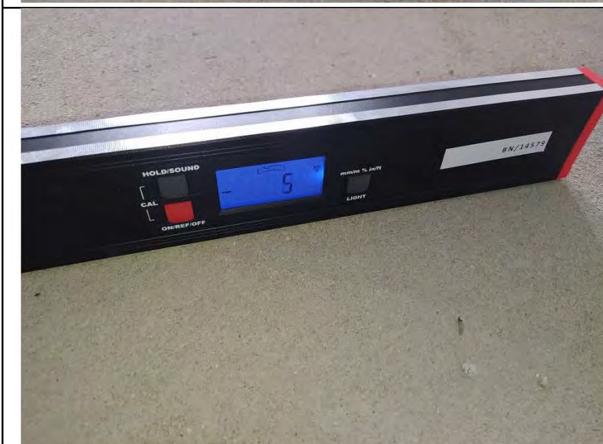
Фото №14. Измерения уровня напольного покрытия в кухне.
