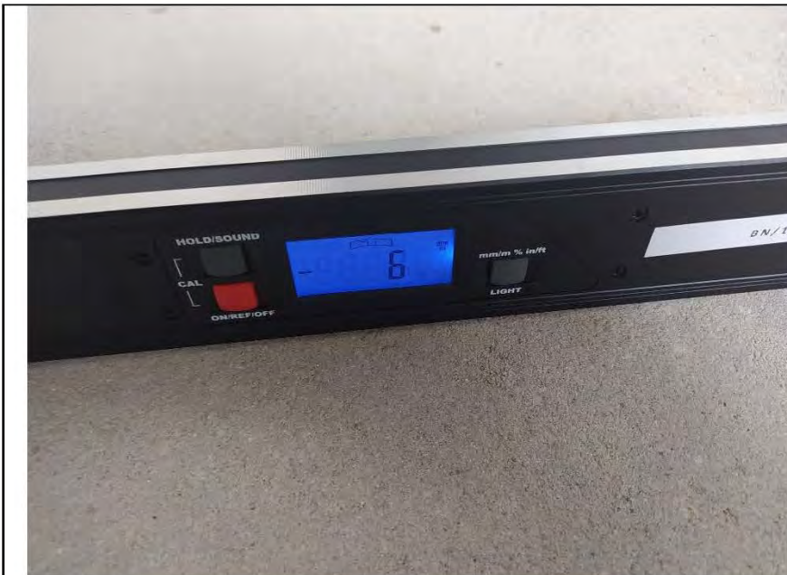
Фото №13. Измерения уровня напольного покрытия в спальне.
