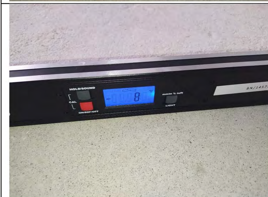
Фото №15. Измерения уровня напольного покрытия в прихожей.
