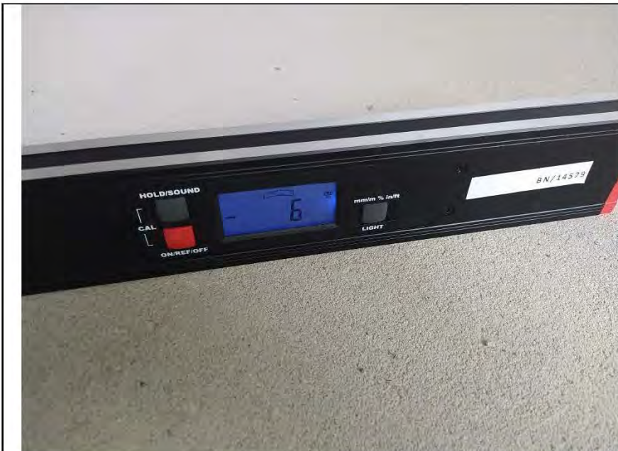
Фото №16. Измерения уровня напольного покрытия в гостиной.
